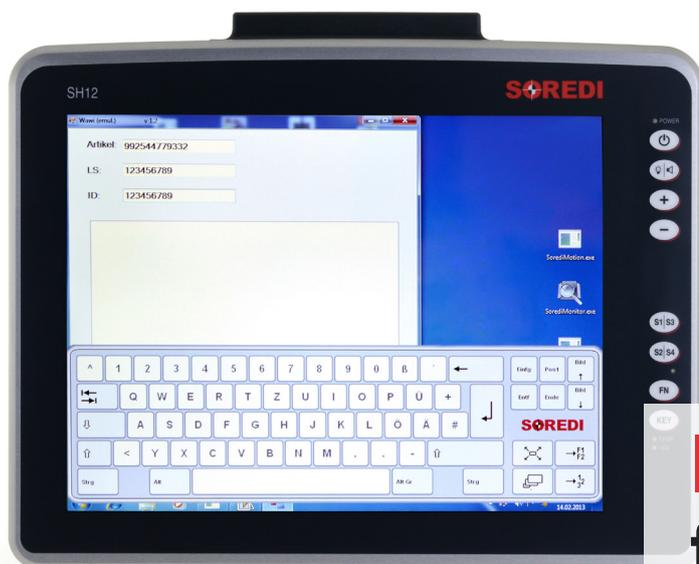
Die leistungsfähigen Industrie-Computer der Baureihe SH, nach der Bildschirmgröße SH10, SH12 oder SH15, bieten hochrobuste, lüfterlose PC-Technologie in einem komplett geschlossenen Gehäuse für den stationären wie mobilen Einsatz.
